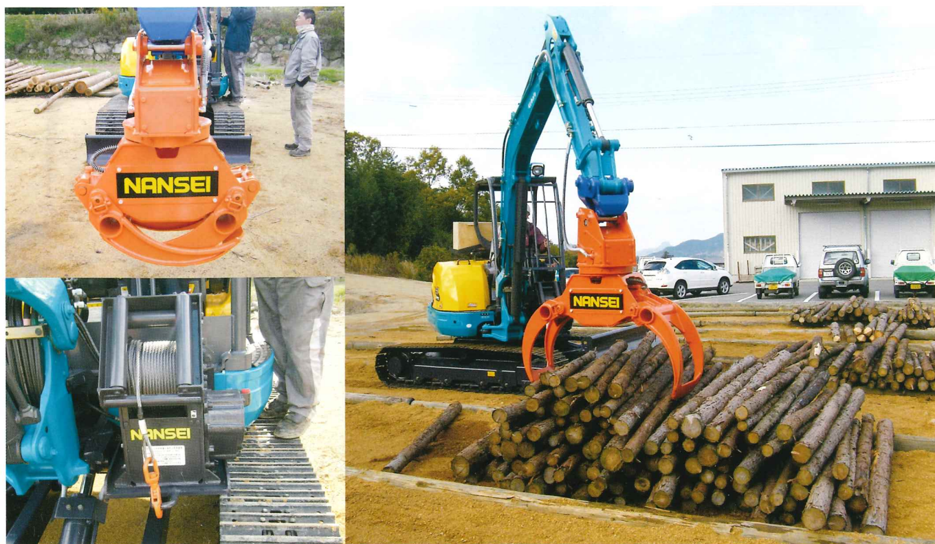
平成20年12月に導入した高性能林業機械(グラップル付バックフォア)
