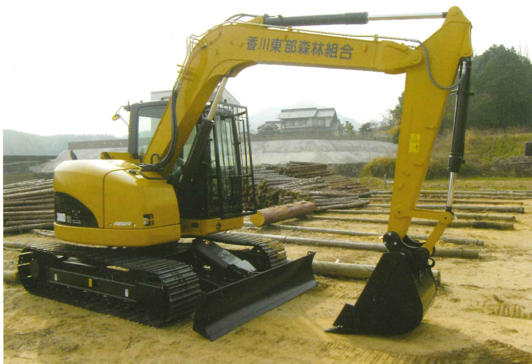
平成23年3月に導入した建設機械(バックホー7tクラス)
