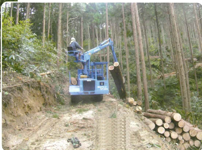
高性能林業機械による間伐材搬出作業
