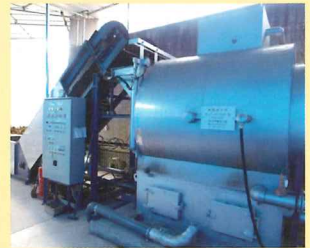
▲薪を投入 ここに投入し時間と温度を設定しておけば自動でボイラー に投入され温度を一定に保ってくれます。
