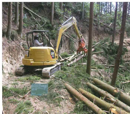
高性能林業機械を使用した作業路の作成、搬出間伐作業
